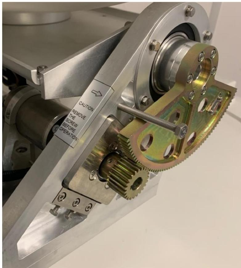
Рисунок 13 – транспортировочный стопор по УГМ
