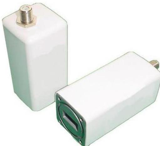
Рисунок 5 – Внешний вид малошумящего блока Ку-диапазона NJR2843SN
