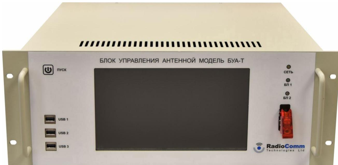
Рисунок 6 – Внешний вид БУА-Т со стороны передней панели изделия
