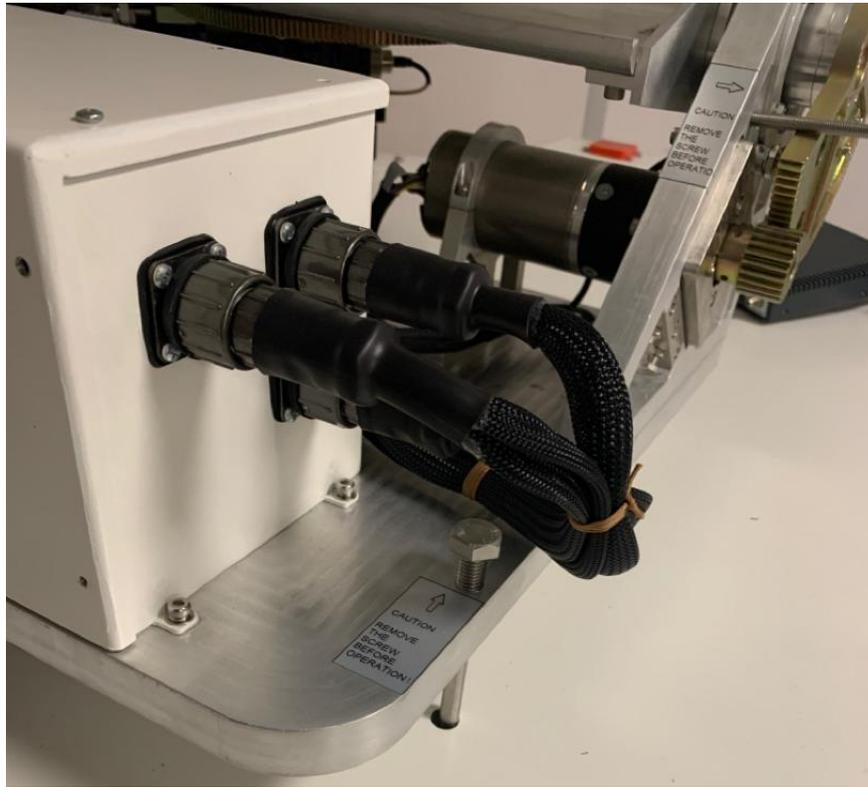
Рисунок 12 – транспортировочный стопор по АЗ
